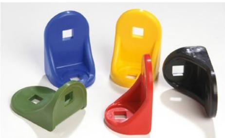
Innenseite zur Verbindung von z.B. HDPE Platten. Eine Seite ca. 60 mm, eine Seite ca. 35 mm, Bohrungen für Schlossschrauben DIN 603 M8, Bohrung an der kurzen Seite gesenkt.
