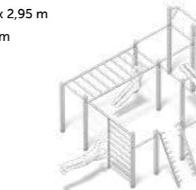
Alle CALISTHENICS-Anlagen sind neben der Basis-Version aus feuerverzinktem Stahl auch duplex-beschichtet (RAL-Farben) erhältlich.
